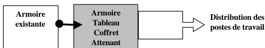
*(\*) l'armoire générale est le tableau divisionnaire de protections électriques de la distribution des circuits terminaux du niveau ou de la zone considérés.*
