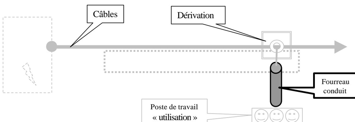
Les conduits et fourreaux sont choisis et mis en œuvre conformément à la réglementation. Le taux d'occupation maximum des fourreaux et conduits sera conforme à la norme NFC15100.
