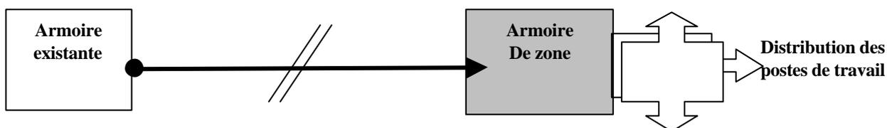
4. L'armoire générale existante a une réserve de place suffisante pour loger les circuits des postes de travail, elle est suffisamment proche de l'installation à créer. Les conditions de mise en place des canalisations sont normales (il n'y a pas de difficultés particulières de passages).
