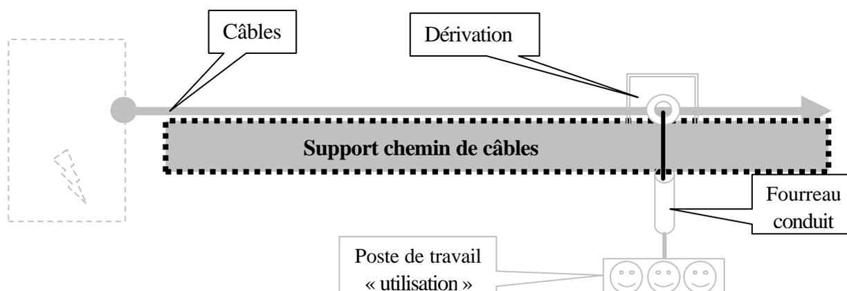
Il sera fait usage de chemins de câbles dans les zones équipées de faux plafonds techniques démontables. L'usage de chemins de câbles sera systématique si plus de 5 câbles cheminent en parallèle sur une distance supérieure à 2.5 mètres.
